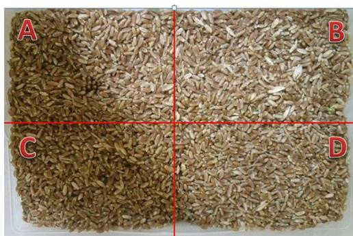
Figura 18 - Redução por quarteamento da amostra.
