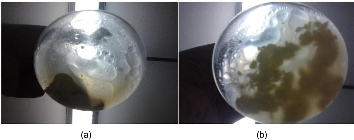
Figura 13 – Gordura de frango liquefeita durante o processo fermentativo em (a) 4,5h e (b) 6h de reação para a concentração de 50% de resíduo graxo
