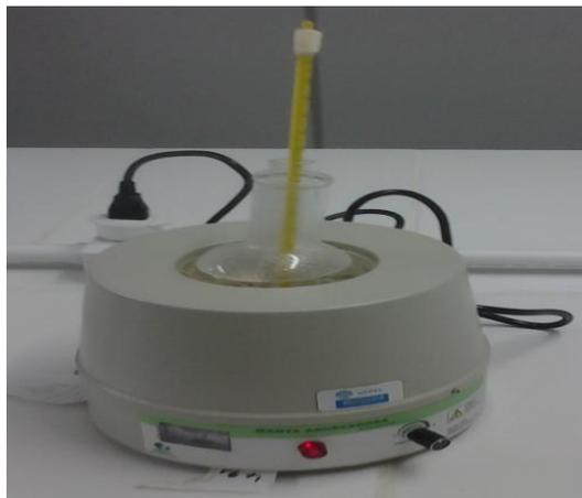
Figura 3 - Aparato aplicado para determinação do ponto de fusão
