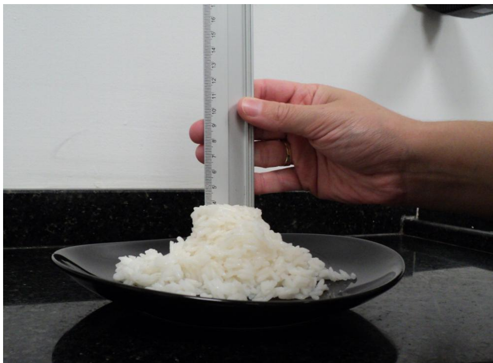
Figura 19. Determinação da soltabilidade – Etapa 4: Medição da maior altura obtida
