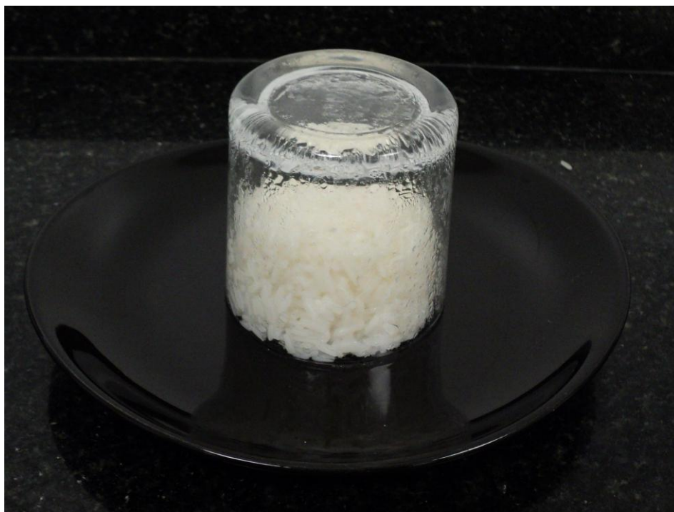
Figura 16. Determinação da soltabilidade – Etapa 1: Preparo da amostra no copo padrão
