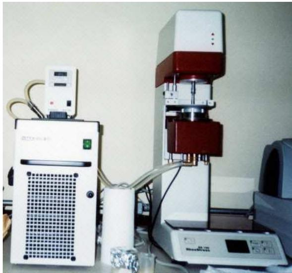
FIGURA 2 – Equipamento utilizado para as análises reológicas, Reômetro Haake RS 150.
