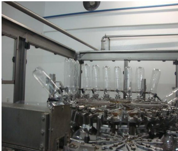
Figura 5: Equipamento rinser para higienização das garrafas PET.
