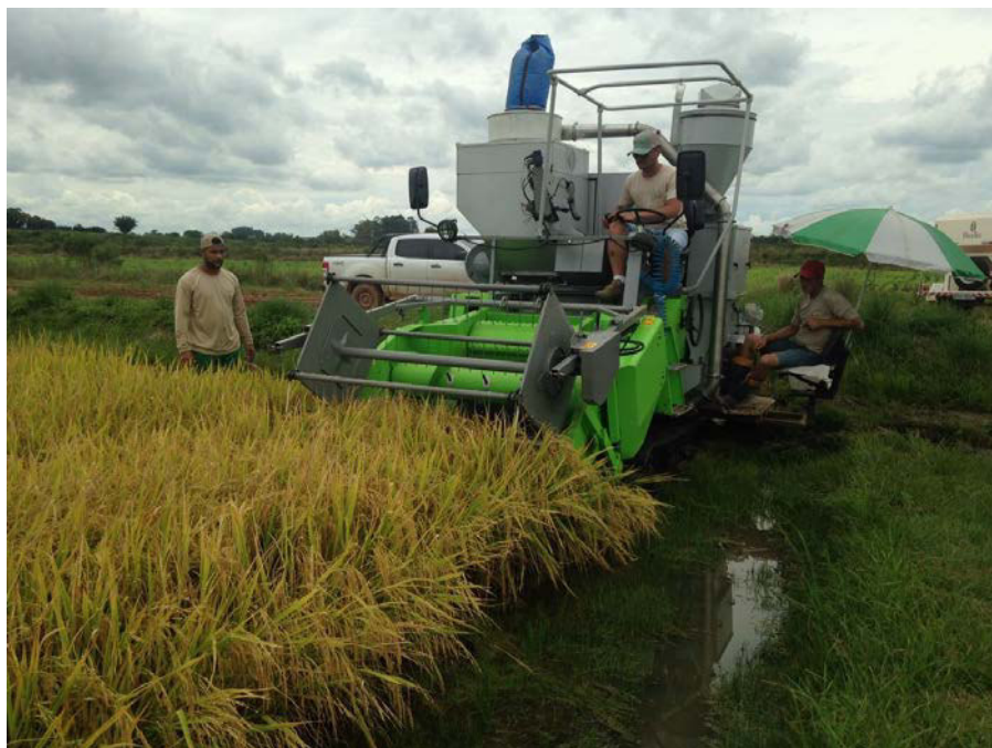
Figura 4 - Colhedora de parcelas utilizada no experimento.
