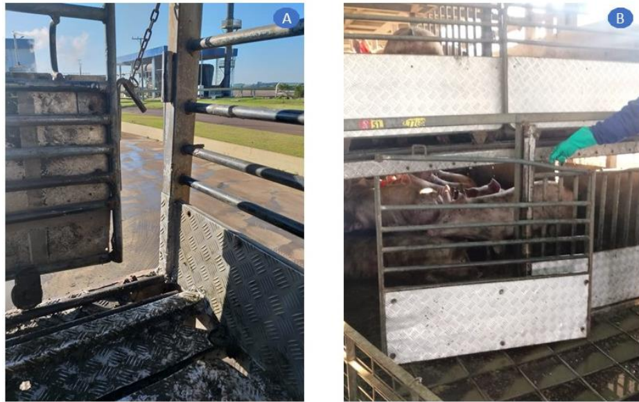
Figura 9 – Fotografias de um portão de carroceria com anomalia no fechamento (A) e outro portão de carroceria quebrado (B), onde os animais podem colocar partes do corpo causando lesões e ou virem a cair do caminhão.
