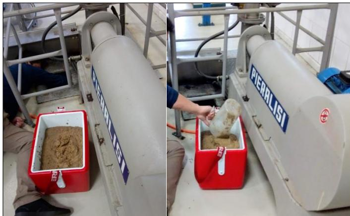
Figura 7 - Coleta do bagaço de oliva após a centrifugação para separação azeite/bagaço.
